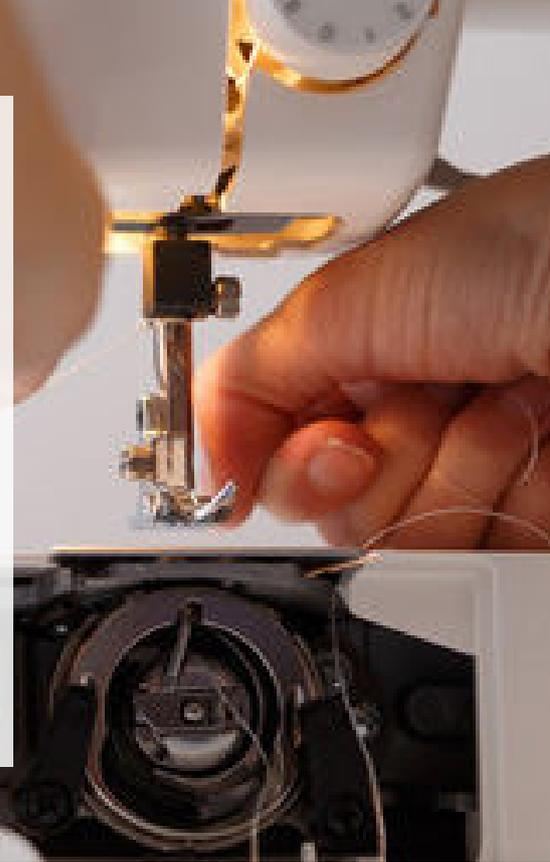
**Abhilfe:** Stellen Sie den Fuß nach oben. Nehmen Sie eine alte Stecknadel und ziehen Sie die Stecknadel zwischen den Spannungsscheiben durch. Versuchen Sie so die Reste (Fadenreste, Flusen) zu entfernen. Seien Sie dabei aber sehr vorsichtig, dass Sie die Scheiben nicht beschädigen. Wenn es nicht funktioniert, keine Gewalt anwenden. Nehmen Sie lieber Kontakt zu uns auf.
