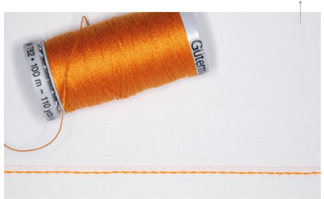
Stellen Sie den Oberfadenspannungsregler auf einen höheren Wert ein, z. B. von 4 auf 6. Was passiert? Die Oberfadenspannung wird fester. Die Verschlingung der Fäden wandert auf die obere Stoffseite. Der Unterfaden ist auf der rechten Stoffseite deutlich zu sehen.
